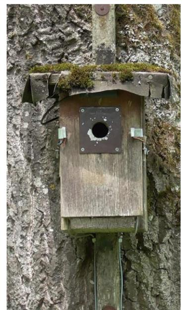
Bild 2.1b: Nistkasten NK\_D1 mit den äußeren Lichtschranken und 32 mm Einflugloch.
