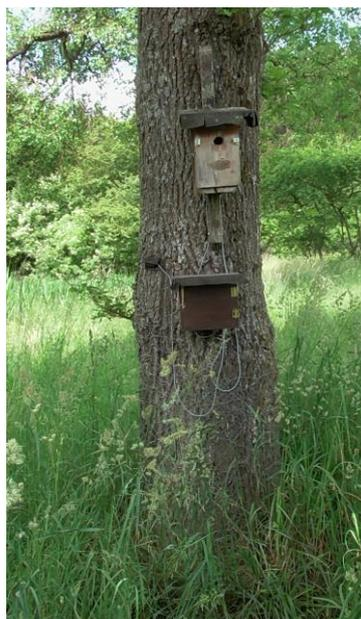
Bild 2.6a: alter Nistkasten NK\_D6 am Baum mit Gehäuse für die Elektronik und dem Akku
