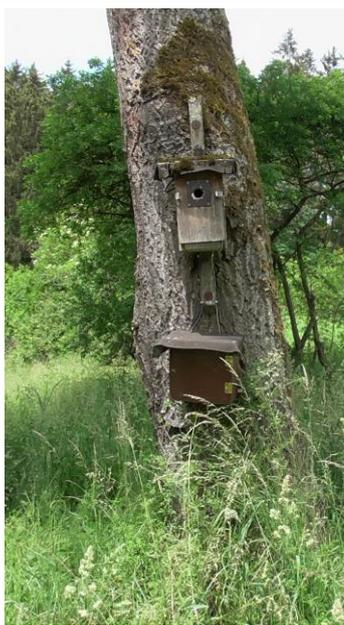
Bild 2.1a: Nistkasten NK\_D1 am Baum mit Gehäuse für die Elektronik und dem Akku.
